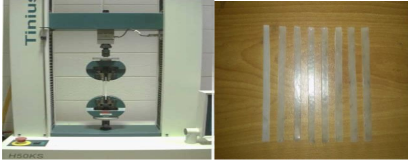
الشكل (4) بعض العينات والجهاز المستخدم في اختبار الشد
