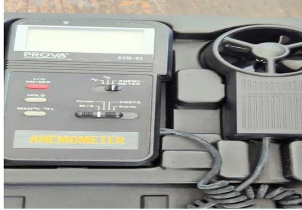
الشكل(4): جهاز قياس درجة الحرارة وسرعة الرياح (ANEMOMETER)
