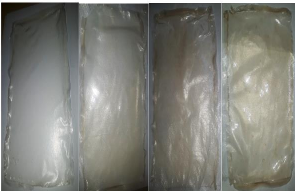
الشكل (2): أغلّفة السّحلب القابلة للأكل وهي بالترتيب من اليسار إلى اليمين (S 1 /G 1.3 ), (S 1 /G 1.3 /PLE 1 ), (S 1 /G 1.3 /PLE 3 ), (S 1 /G 1.3 /PLE 5 ).
