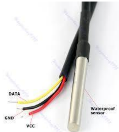
الشكل (6) حساس الحرارة المستخدم لقياس حرارة اللوح PV
