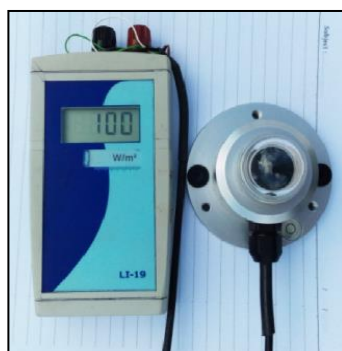
الشكل (1) جهاز قياس شدة الاشعاع الشمسي والحساس الضوئي
