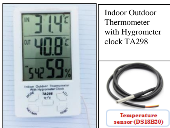
الشكل (2) حساس قياس درجة حرارة الماء مع المجس الحراري
