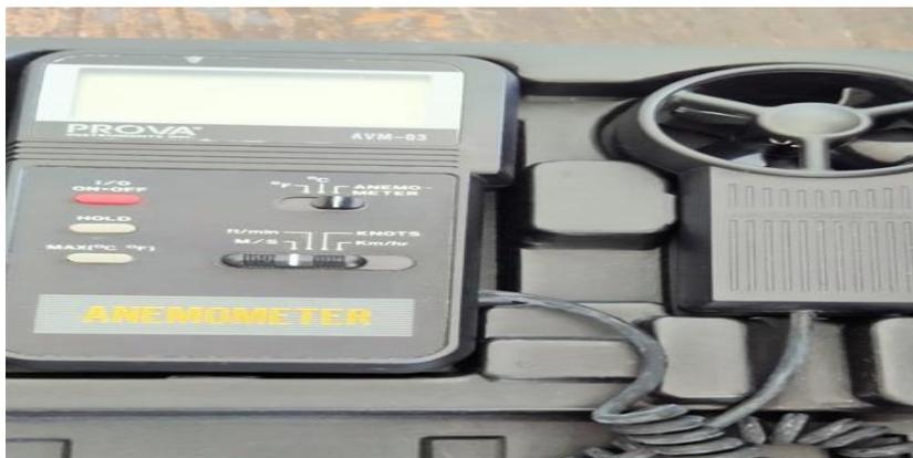
الشكل(4): جهاز قياس درجة الحرارة وسرعة الرياح (ANEMOMETER)
