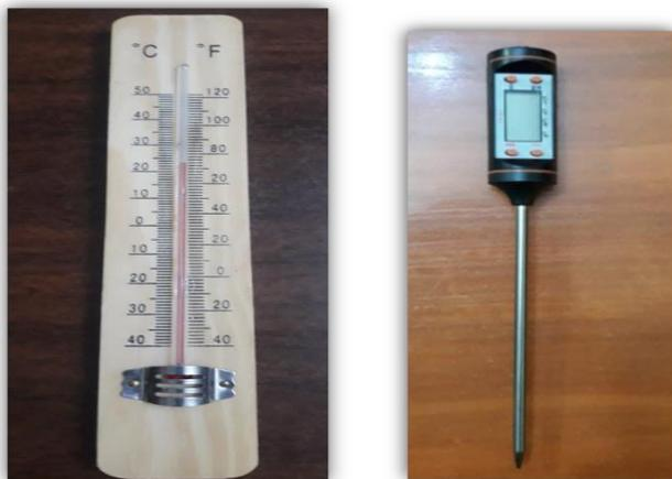
الشكل (6) حساس حراري. الشكل (7) مقياس درجة الحرارة.
