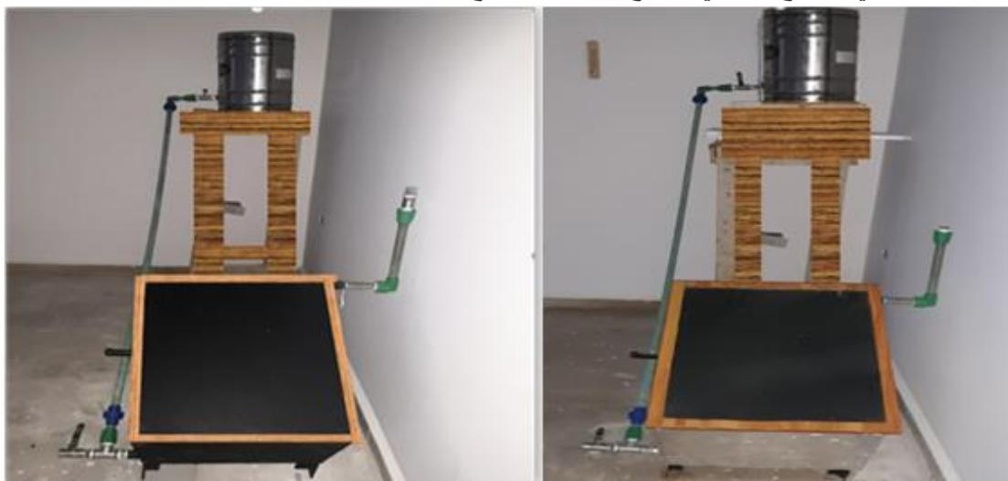
الشكل (8) المجمع الشمسي المدمج المستخدم مع عزل الشكل (9) المجمع الشمسي المدمج المستخدم بدون عزل
