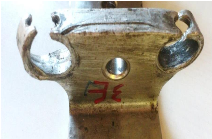
الشكل (5) الانهيار الحقيقي في منطقة التمثفصل لعينة مستخدمة
