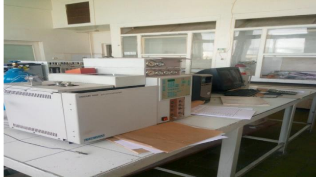
الشكل (13): جهاز الكروماتوكراف المستخدم في المخبر المركزي بمصفأة بانياس.
