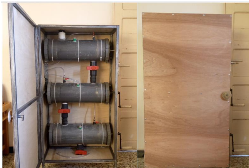
الشكل (11): المفاعل الحيوي ثلاثي المراحل.
