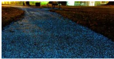
الشكل (1): الإسمنت الباعث للضوء باللون الأخضر أو الأزرق (Han et al, 2017,pp-).
