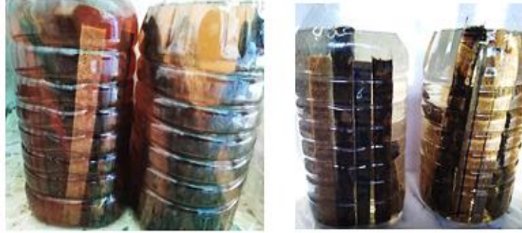
الشكل (7) - صورة توضح تغير لون العينات و تعكر المياه في نهاية مدة الغمر.
