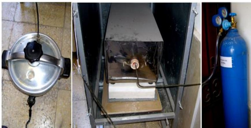
الشكل (2): فرن كهربائي للمعالجة الحرارية مزود بأسطوانة من غاز الأمونيا إضافة إلى مبخر للماء المقطر
