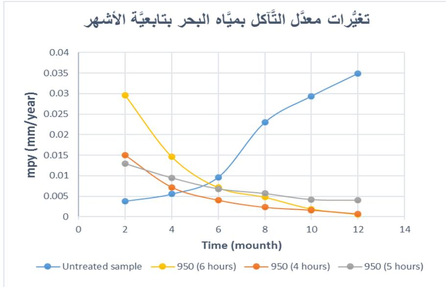
الشكل (5) يبيّن معدّل التآكل للعينات المغمورة بمياه البحر 950 °C
