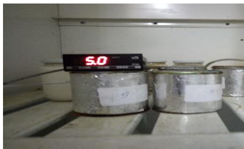
الشكل (5): محطة قياس درجة حرارة العينة في أثناء التبريد الأولي: A - صورة B - مخطط رمزي للاختبارات الكيميائية والفيزيائية:
