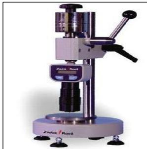
الشكل (6) جهاز اختبار القساوة
