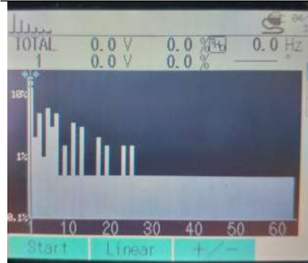
الشكل (٧) النتائج التي حصلنا عليها بواسطة جهاز محلل القدرة.
