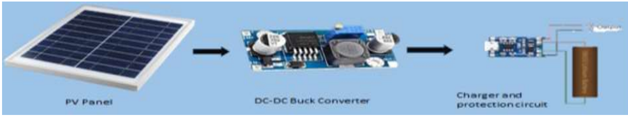
الشكل (20): بنية النظام الكهروضوئي المستخدم لتغذية النظام الري
