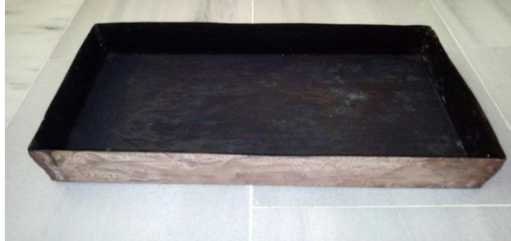
الشكل (4) خزان الماء ضمن المقطرين المنفذ.
