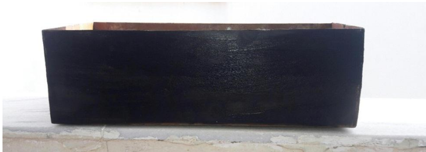
الشكل (5) خزان المادة الماصة في المقطر المنفذ.
