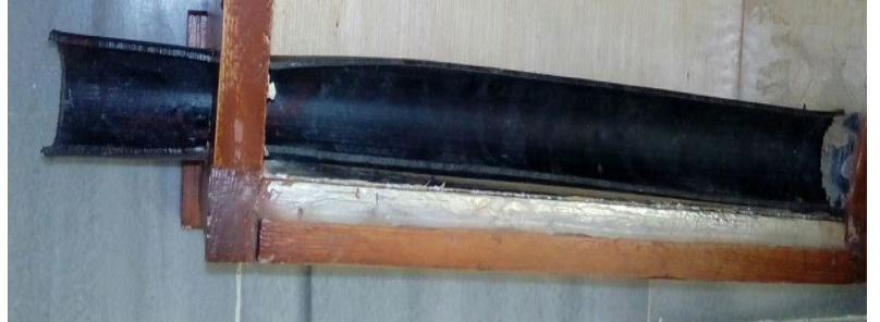
الشكل (7) أنبوب تجميع الماء.
