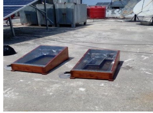
الشكل (1) المقطرين الشمسيين المصنوعين أحدهما مزود بالرمل الحراري الأسود والثاني من دون رمل.
