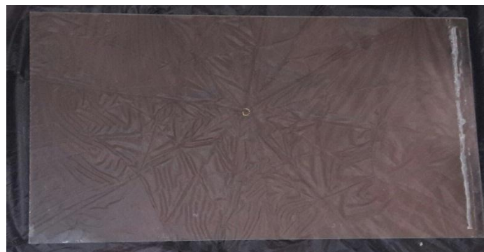
الشكل (6) الغطاء الزجاجي للمقطرين المنفذ.
