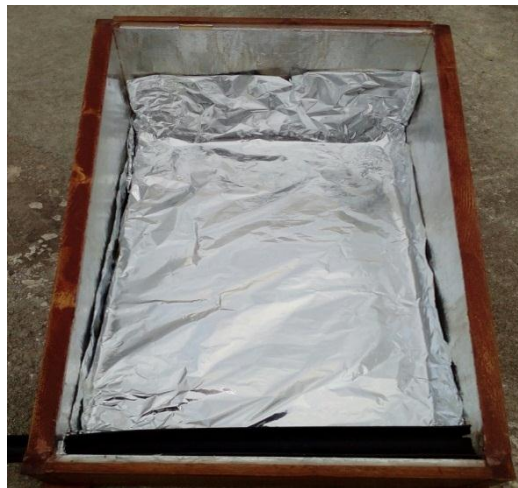
الشكل (٣) حوض المقطر المعزول بالسلفوفان.
