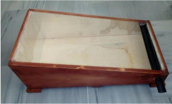
الشكل (2) الهيكل الخارجي للمقطر المنفذ.
