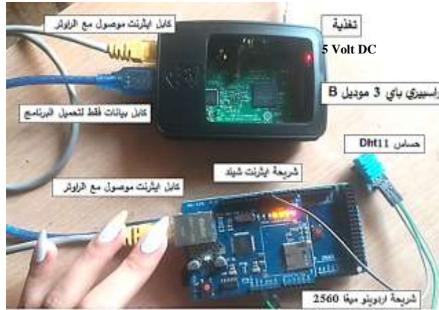
الشكل (١٧): عملية تسجيل البيانات من الحساس وإرسالها إلى قاعدة البيانات المُصمّمة في الـ راسبيري باي.
