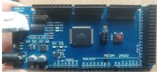
الشكل (٣): Arduino MEGA2560
