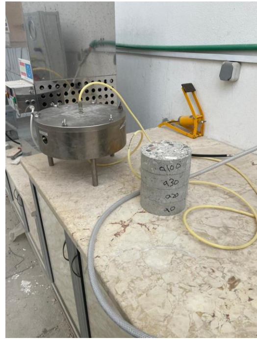
الشكل (٥) عينات البيتون عند التجفيف وأثناء الاختبار
