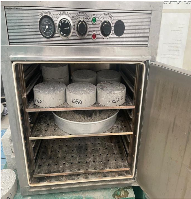
الشكل (٥) عينات البيتون عند التجفيف وأثناء الاختبار
