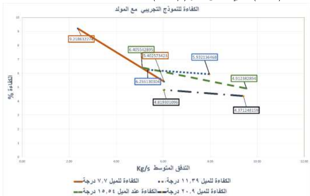
الشكل (10) الكفاءة للنموذج التجريبي متضمناً المولد مع التدفق بالنسبة لزوايا ميل مختلفة
