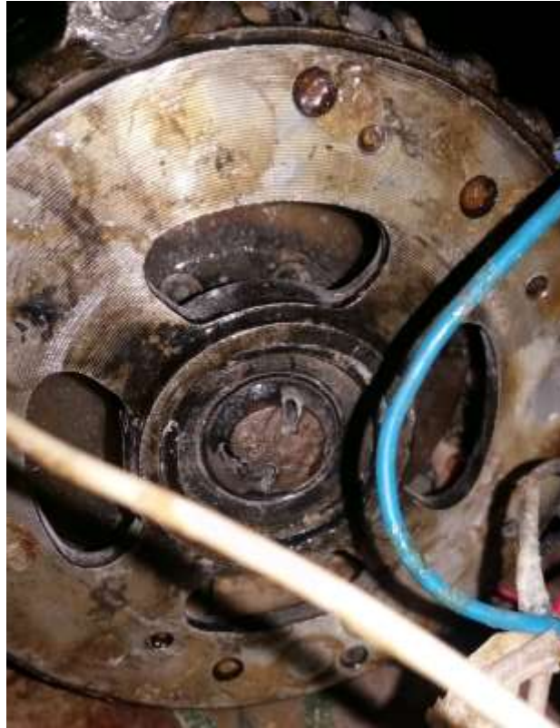
الشكل (3) المولد المصنوع يدوياً ذو الدائر المغمر بالإيبوكسي
