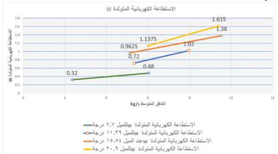
الشكل (9) الاستطاعة الكهربائية الناتجة عن المولد مع التدفق بالنسبة لزوايا ميل مختلفة
