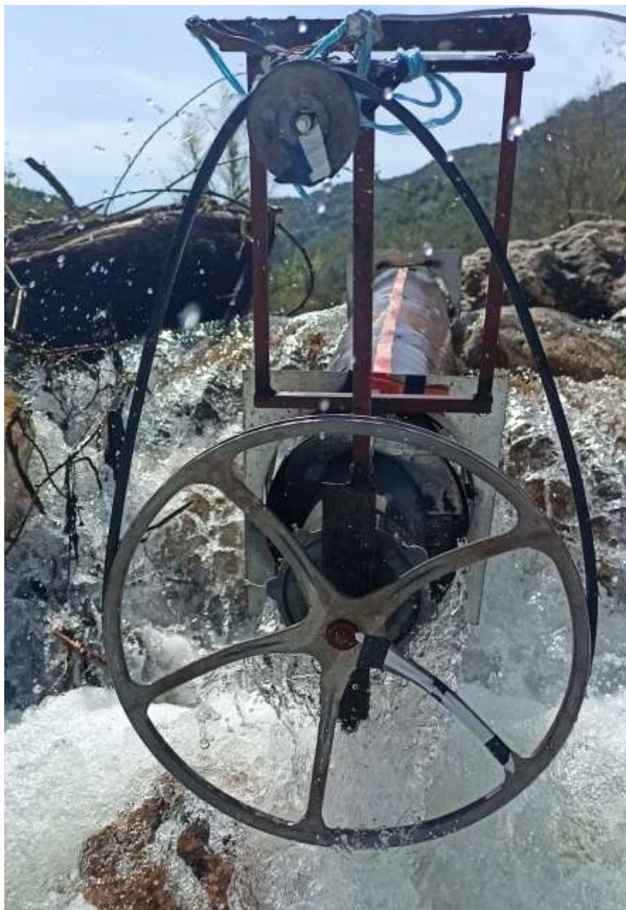
الشكل (2) العنفة الحلزونية بالشكل النهائي مع نظام تحويل السرعة
