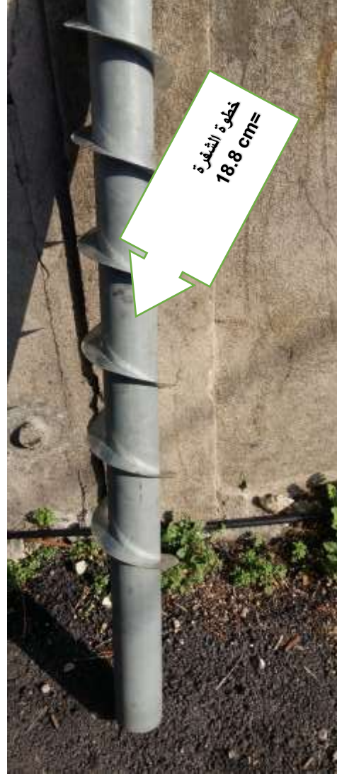
الشكل (1) الجزء الدوار من العنفة الحلزونية والعنفة بعد التركيب والفجوة بين الشفرات والمجرى
