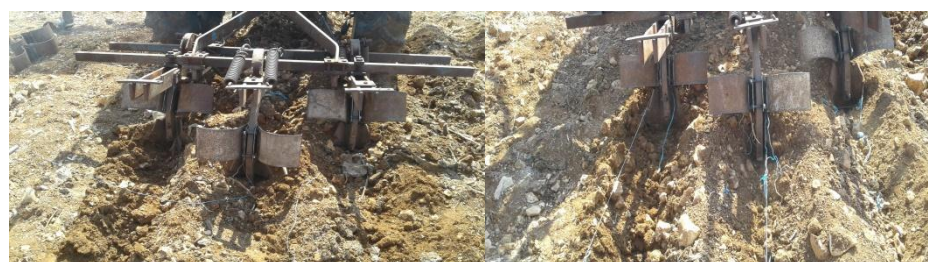
الشكل (5): a, b, c, d - المحراث بعد التعديل (النماذج 1, 2, 4, 5 على التوالي)
