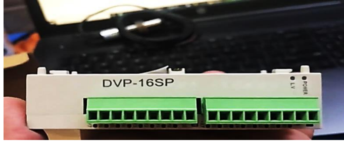
الشكل (7): المُتَحَكِّم المنطقي القابل للبرمجة نوع DVP-16SP PLC
