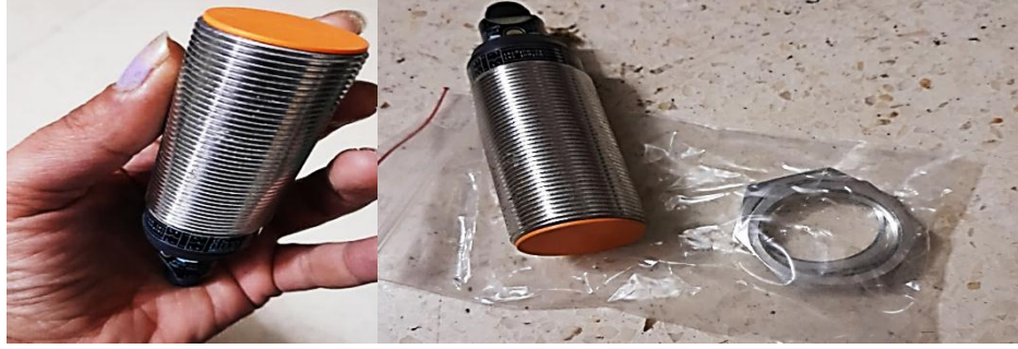
الشكل (9): الحساس السعودي "KN5100 KNM30BSAFPKG/US"
