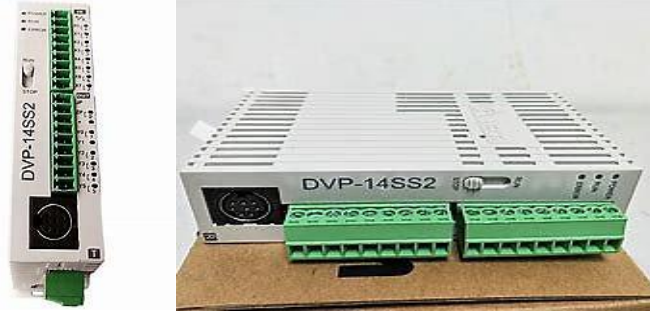
الشكل (6): المُتَحَكِّم المنطقي القابل للبرمجة نوع DVP-14SS2 PLC
