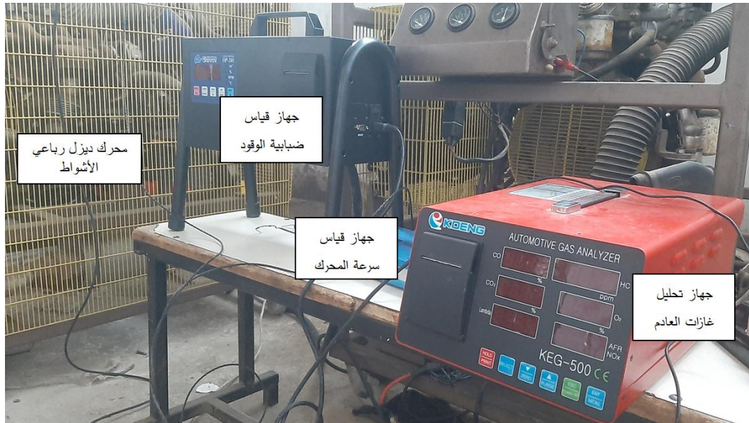
الشكل (1) التجهيزات التي تم استخدامها لاختبار العينات على محرك ديزل رباعي الأشواط.
