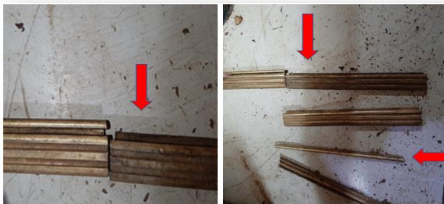
الشكل (١) مراحل تشكل الشقوق وانفصال جزء من لوحة الوصل النحاسية عنها بعد تشققها و انكسارها (الملاحظات المرئية في موقع العمل)
