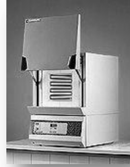
الشكل (٦) الفرن المستخدم نوع (Curbolite, Hope Watt: 3100 W)
