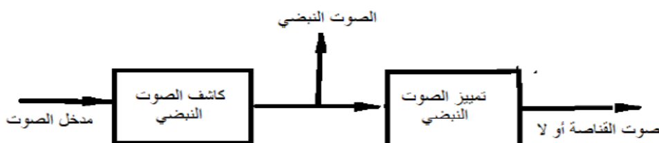
الشكل ( 2 ) نظام الكشف عن الصوت المندفع والتعرف على الطلقات النارية
