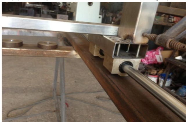
الشكل (8) تركيب المحور Y مع المحور X.
