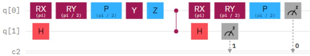
الشكل (5): يوضح الدارة الكمومية المستخدمة لتجربة ماخ زيندر مع الجسم الماص للفوتونات.
