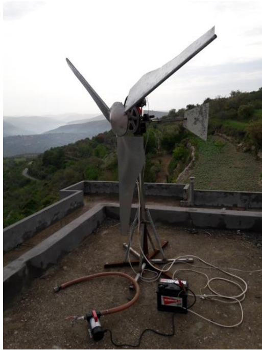
الشكل (1) : المخطط الصندوقي وصورة لنموذج العنفة المصممة والمستخدم في نظام الضخ الكهروريحي.
