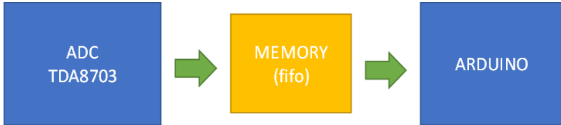
الشكل (10) المخطط الصندوقي لطريقة حل مشكلة فرق السرعة بين المتحكم والمحول الخارجي
