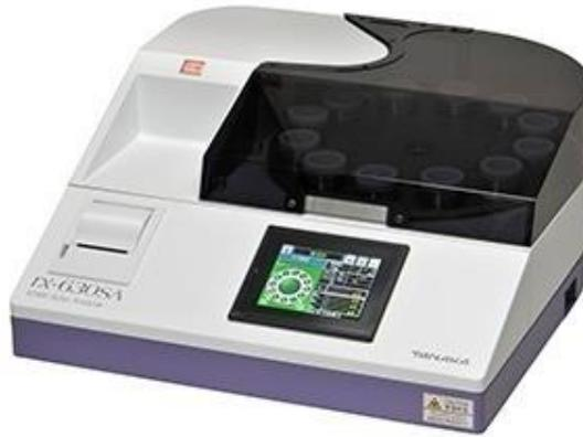
الشكل (7): جهاز (Sulfur Meter R-X 360S-H TANAKA) لقياس نسبة الكبريت في الوقود
