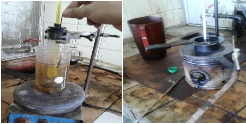
الشكل (5) : قياس نقطة الوميض بالشكل (6): قياس نقطة الإنثين
