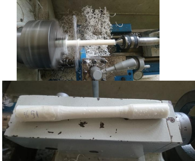
الشكل ٦: إجراء عملية الخراطة للحصول على عينات الشد(يمين) وعينة الشد (يسار).
