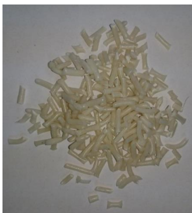
الشكل ٤: العينات بعد خروجها من الجهاز وتقطيعها يدوياً
