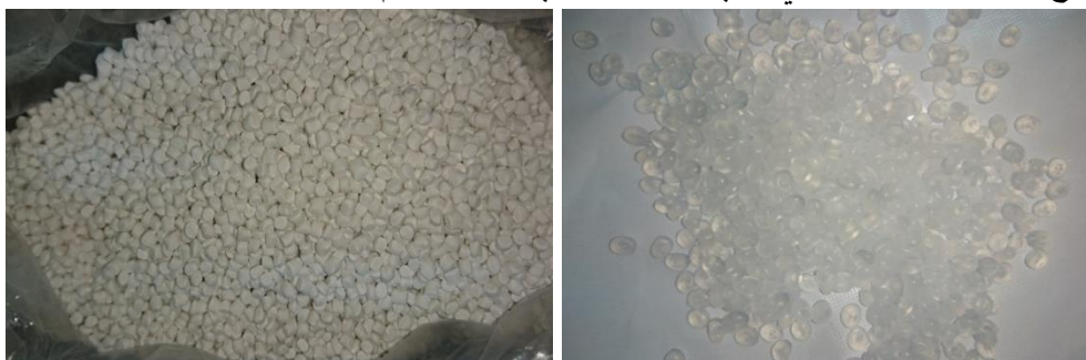
الشكل 3 حبيبات PP (يمين) وحبيبات CaCO_3 (يسار) المستخدمة
