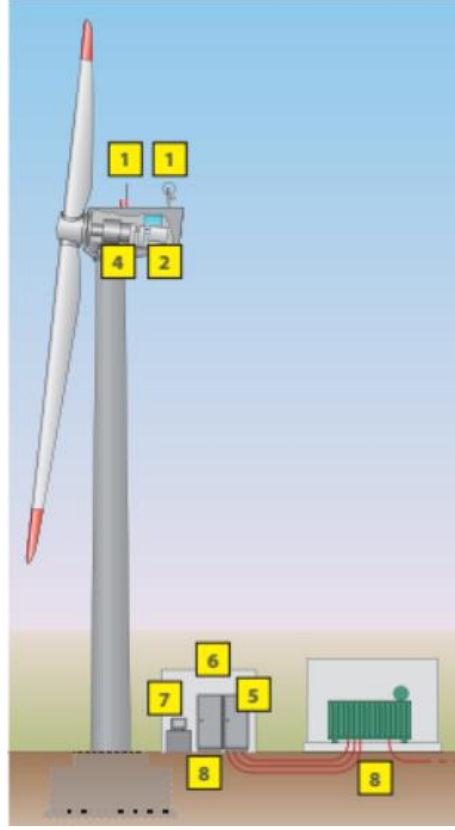
الشكل (6): مخطط كل مكونات العنفة الريحية المطلوب حمايتها:
