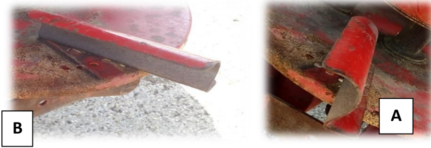
الشكل (5):صورة توضح كيفية توضع الزعانف على القرص في الحالتين A&B.
