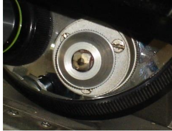
الشكل (٦) يبين الهرم الماسي المستخدم لاختبار القساوة
