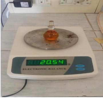
الشكل (6): جهاز البيكنومتر لقياس الكثافة
