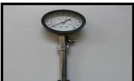
الشكل (4) ساعة الضغط لقياس ضغط الانضغاط
