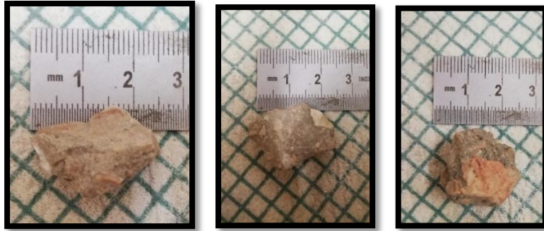
الشكل (1) البنية التركيبية لحصىات RCA
