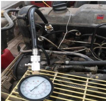
الشكل (10): تركيب ساعة قياس الضغط
