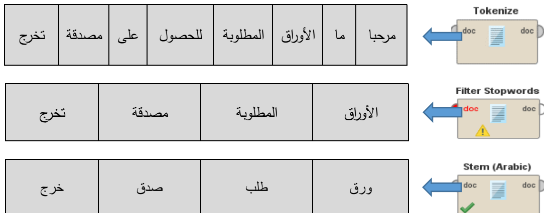
الشكل (1) عمليات المعالجة المسبقة للنص
