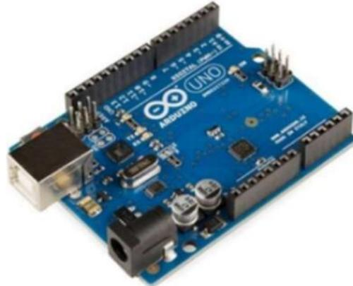
الشكل (4). لوحة Arduino Uno.
