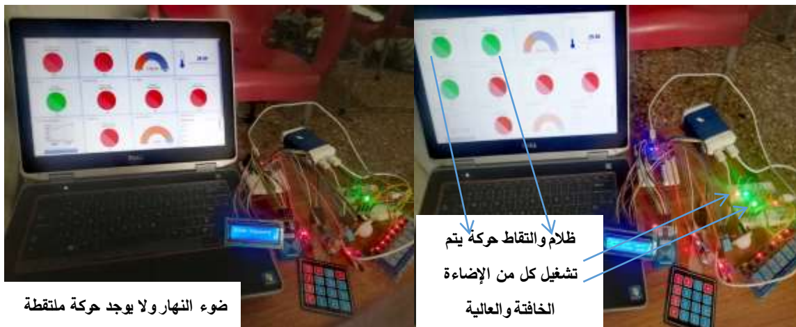
الشكل (29): اختبار نظام الإنارة المرتبط بضوء النهار والحركة
