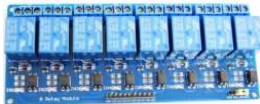
الشكل (9): وحدة مرحلات ذات الثمان قنوات
