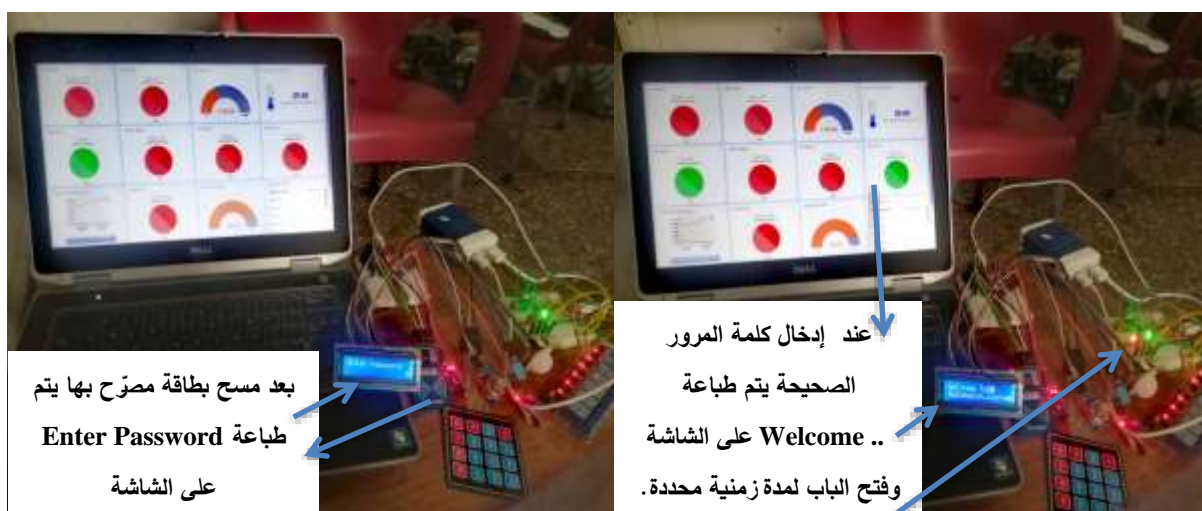
الشكل (31): اختبار نظام الامن للدخول للمنشأة
