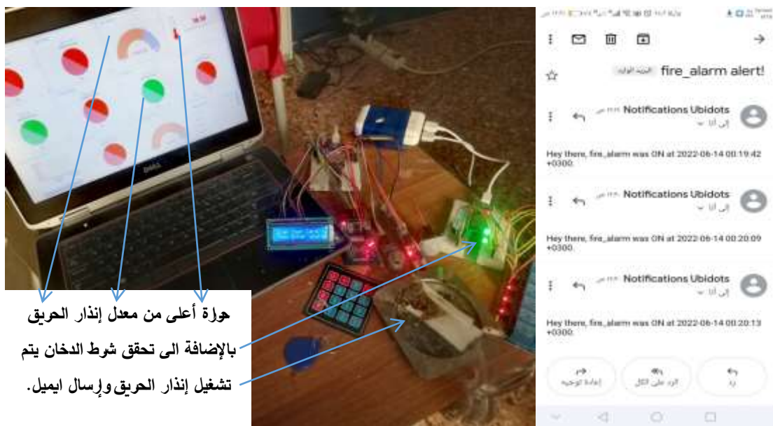
الشكل (30): اختبار نظام إنذار الحريق حالة تحقق شرط الحرارة مع شرط الدخان
