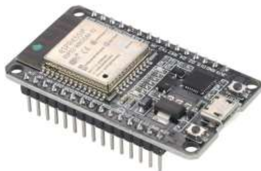
الشكل(12): المتحكّم الرقمي ESP32-WROOM 32S
