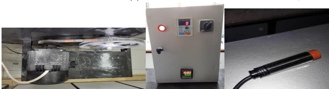
الشكل (8): وحدة التحكم مع الحساس والمحرك الكهربائي المستخدم
