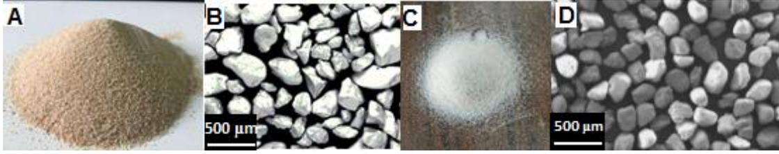
الشكل (5): A: الرمل النبكي، B: الرمل النبكي تحت المجهر، C: السيليكا بصورتها النهائية، D: رمل السيليكا تحت المجهر الضوئي
