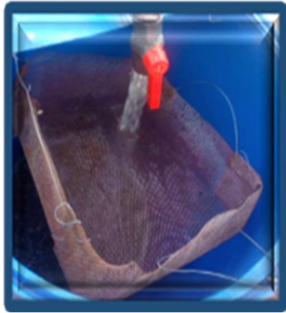
الشكل (3): منخل ضمن خزان الترسيب
