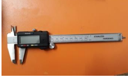
الشكل (٣-٢): المسطرة الرقمية
