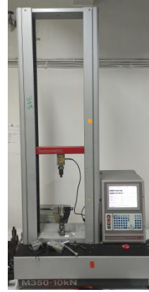
الشكل (٣-١٠): جهاز Universal machine لاختبار مقاومة الكسر العمودية
