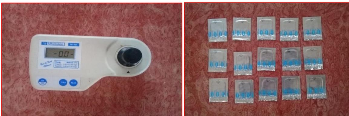
الشكل رقم ( 3 ) جهاز قياس الكلور الحر المتبقي ( Milwaukee MI 404 ) وكواشف ( DPD ) .
