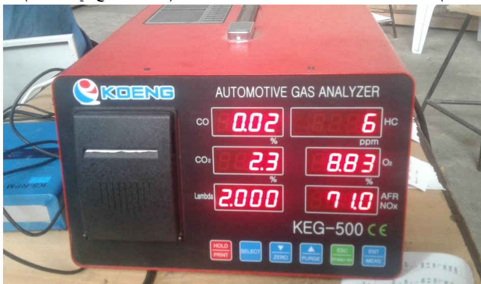
الشكل (3): جهاز تحليل غازات العادم (KEG-500)
