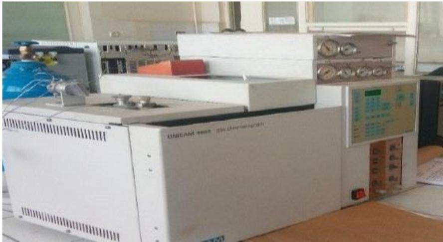
شكل (3) جهاز غروموتوغرافيا لتحليل الغاز الحيوي .
