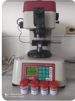
صورة رقم (١٠) جهاز فيكرز للقساوة نوع Galileo Durometra , Mod: Isoscan Od
