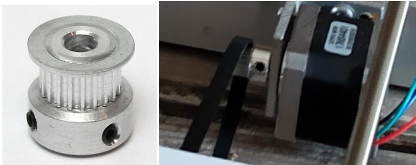
الشكل (5): المحرك الخطوي المستخدم لتحريك أرضية الطباعة.
