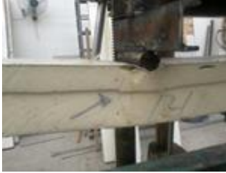
d: صورة لعينة تظهر التشوه موضعي الحاصل عند حدوث الانهيار مع انفصال لمادة النواة
