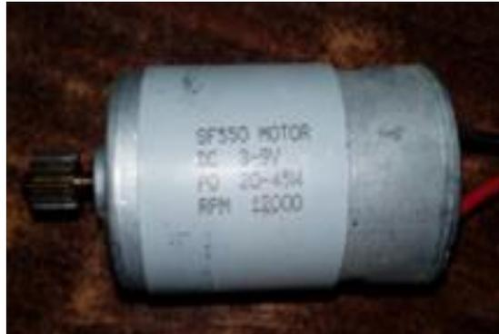
الشكل (13) المحرك الكهربائي المستخدم في التجربة.
